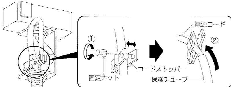
③保護チューブを持って、電源コードの長さを調整する。
