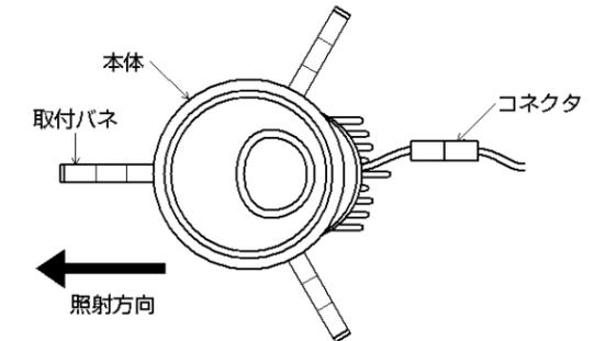
△警告 取付け後、電源線が器具に触れないようにしてください。火災・感電の原因になります。
