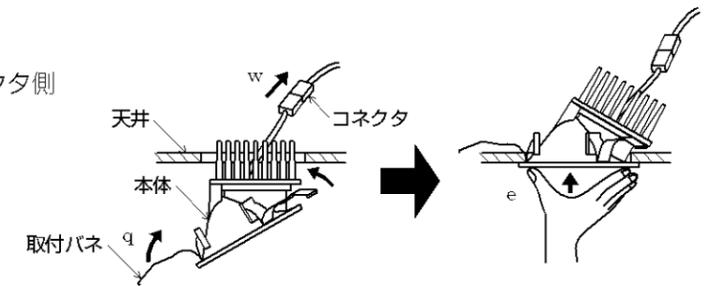
※照射方向を確認の上、取付けてください。
