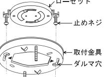
取付金具の矢印(tS)を止めねじに合わせて締め
