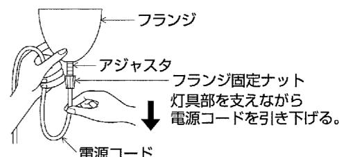
※電源コードの調整が固い場合は、一旦、フランジ固定ナットをアジャスタから取外し、もう一度2回転程締め付け、仮止めしてください。
