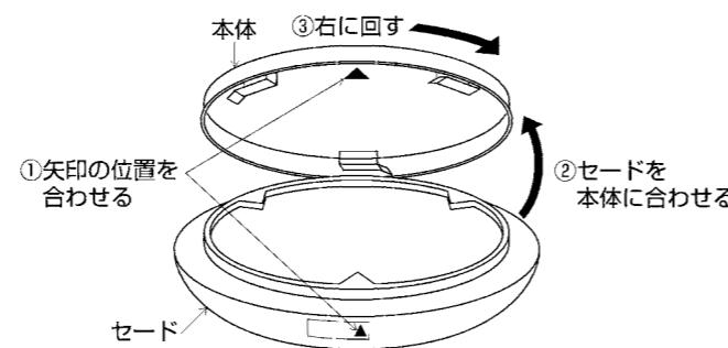
△警告 セードが確実に取付いたことを確認してください。取付けが不完全な場合、落下によるけがの原因になります。
