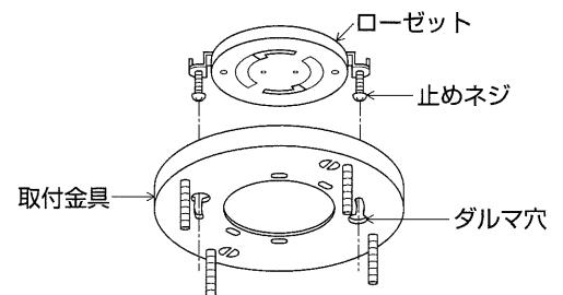
取付金具を回転させ、止めネジを締め付ける。
