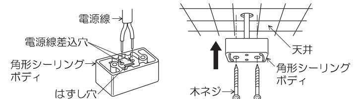
■取付手順 △注意 取付けの際は必ず電源を切ってください。感電の原因になります。
