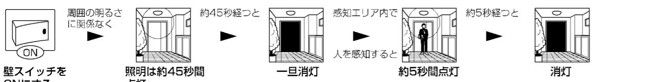
※感知エリアはセードの形状、気温、移動速度、進入方向、人の服装などにより変化しますので、あくまで目安としてください。
