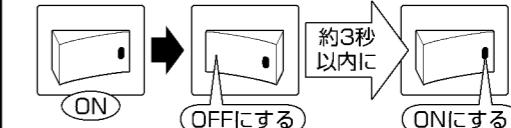
※連続点灯状態に切り替え後、約8時間で自動的にセンサ待機モードに戻ります。また、連続点灯中に壁スイッチ操作(約3秒以内にOFF→ON)を行なった場合、再度その時点から約8時間の連続点灯モードになります。
