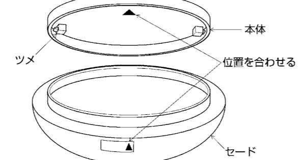
※取付けの際、セードのセンサ用穴をセンサ部に合わせてください。
