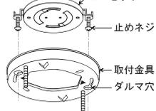
取付金具の矢印(ts)を止めネジに合わせて締め付ける。
