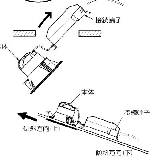
※天井材厚が薄い場合、天井との間に隙間が空くことがありますので、この場合は一度バネを押し広げてから埋込穴に挿入してください。
