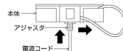
②押し込んだ電源コードを本体側面で束ね、コード押さえに引っ掛ける。
