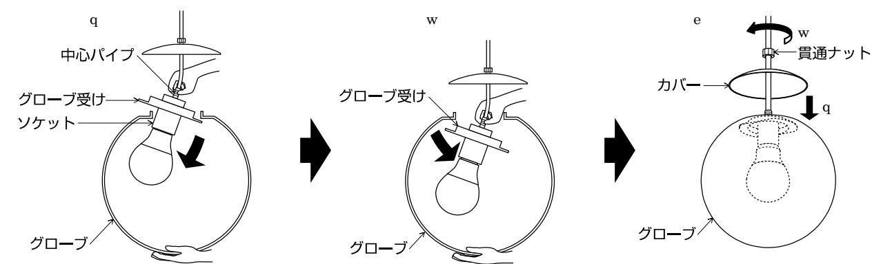
カバーの長穴を利用してカバーが水平になるように調整する。
