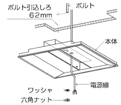
※六角ナットの締付トルクは0.8N・m以下です。締付トルクが適正値を超えると、器具変形・天井面とのすきまの原因になります。すきまを確認しながら締め付けを調整してください。
