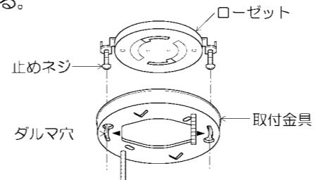
取付金具の矢印(◀▶)を止めねじに合わせて締め
