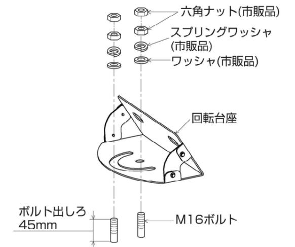
●本体のアームを回転台座に合わせ、六角ボルト、六角ナット、スプリングワッシャ、ワッシャ(付属品)で取付ける。
