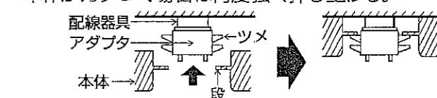
△警告 解除レバーの緑の矢印の先端が、アダプタの赤い矢印の先端にくるまで本体を押し上げてください。取付けが不完全な場合、落下によるけがの原因になります。
