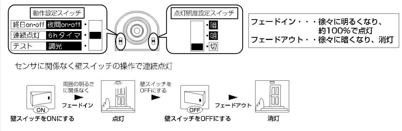
※電源投入後、約20秒間点灯し、その後約40秒間に明るくても人を感知するごとに約5秒間点灯します。
