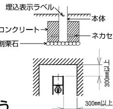
2 施工に関しては電気設備基準・内線規程に従って行なう
