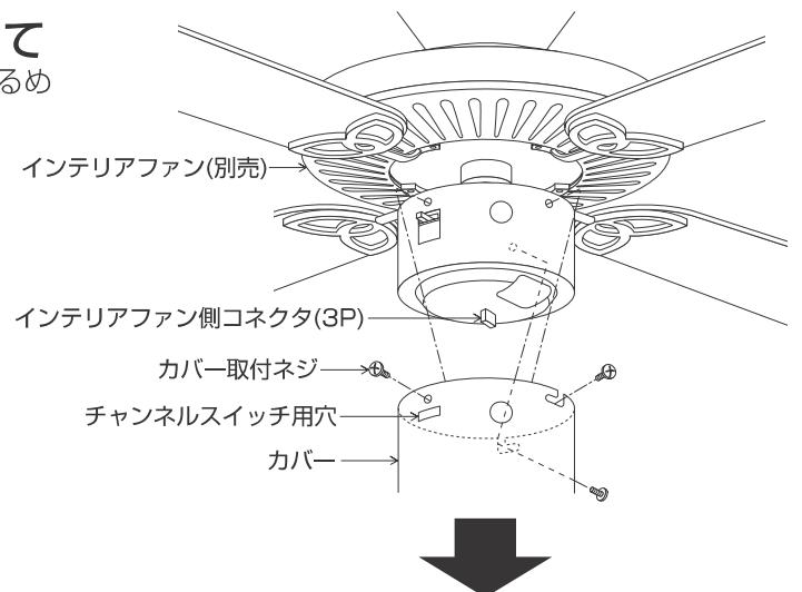
取外したカバー取付ネジのうち2本をインテリアファンに仮止めする。
