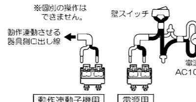
※動作連動子機用の接続端子には絶対に電源線を接続しないでください。
