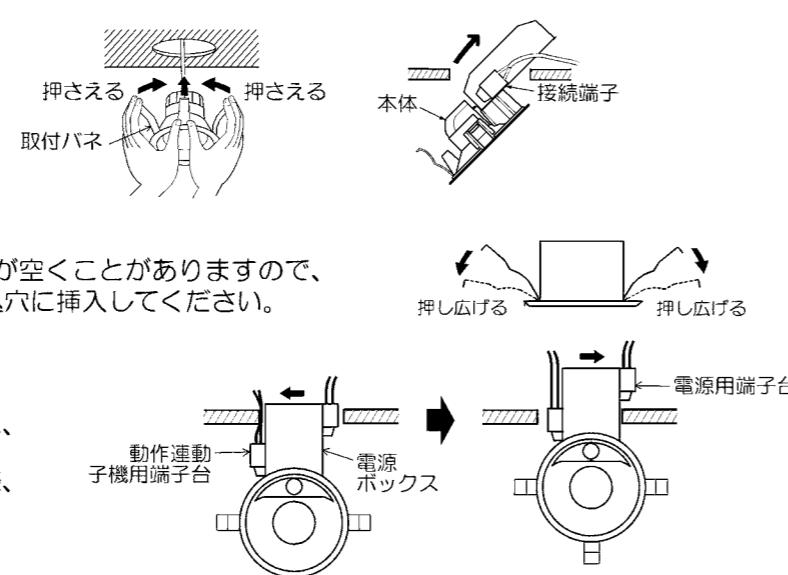
※電源用の配線は挿入の邪魔にならない様に、電源ボックス側にそわせてください。
