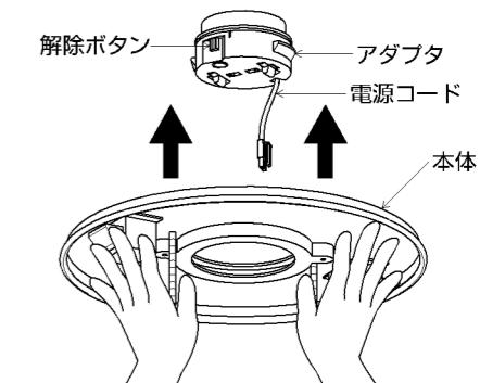
△警告 解除レバーの矢印の先端が、アダプタの矢印の先端にくるまで本体を押し上げてください。
