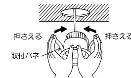
※天井材厚が薄い場合、天井との間に隙間が空くことがありますので、この場合は一度バネを押し広げてから埋込穴に挿入してください。
