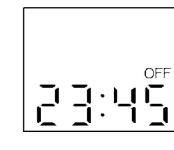
※解除する場合は、OFFタイマーボタンを1回押して液晶パネルの**OFFタイマー**表示を消してください。
