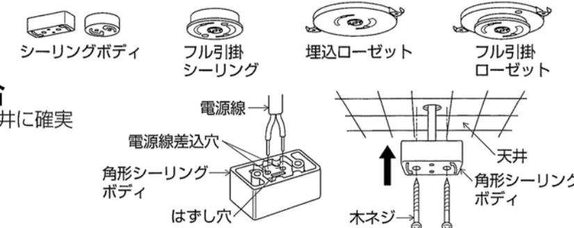
■取付手順 △注意 取付けの際は必ず電源を切ってください。感電の原因になります。
