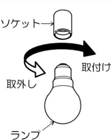
■グローブの取外し方 △注意 グローブ取外しの際は安全のため電源を切ってください。感電の原因になります。
