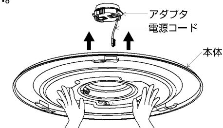
**△警告** 解除レバーの矢印の先端が、アダプタの矢印の先端にくるまで本体を押し上げてください。取付けが不完全な場合、落下によるけがの原因になります。
