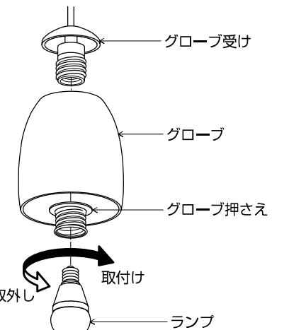
■ランプ交換について △注意 ランプ交換の際は安全のため電源を切ってください。感電の原因になります。
