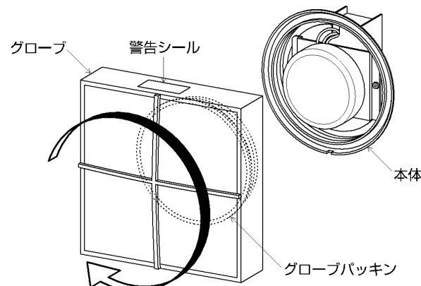
グローブ取付け開始位置      グローブ取付け後
