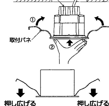
※天井材厚が薄い場合、天井との間にすきまが空くことがありますので、この場合は一度バネを押し広げてから埋込穴に挿入してください。
