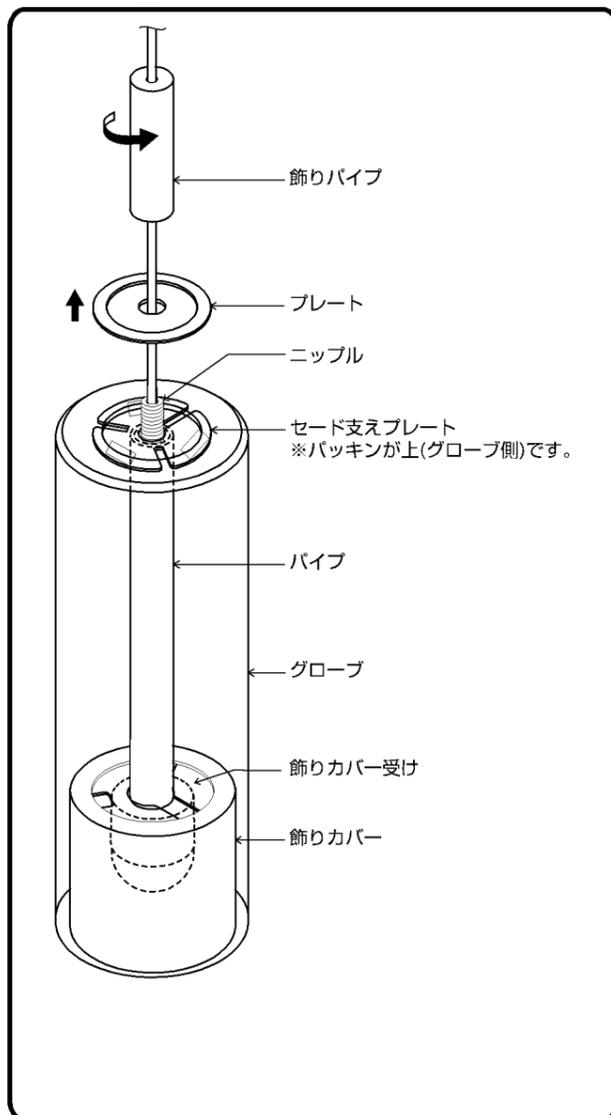
【手順2】 セード支えプレートがグローブ天面内側中央にくるようにあわせる。
