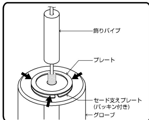
※セード支えプレートについている3つのパッキンがグローブ天面(内面)に接触していることを確認してください。
