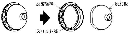
レンズまたはフィルターを反射板枠に入れ、グレアキャップを反射板枠のミゾにはめ込み、反射板のストレート部を反射板枠のバネ部に合わせて確実にはめ込む。
