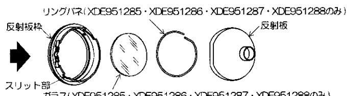
レンズまたはフィルターを反射板枠に入れ、リングバネを取付けて固定し、反射板のストレート部を反射板枠のバネ部に合わせて確実にはめ込む。取付けが不完全な場合、落下によるけがの原因になります。
