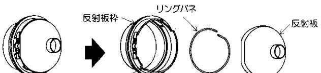
レンズまたはフィルターを反射板枠に入れ、グレアキャップを反射板枠のミゾにはめ込み、反射板のストレート部を反射板枠のバネ部に合わせて確実にはめ込む。
