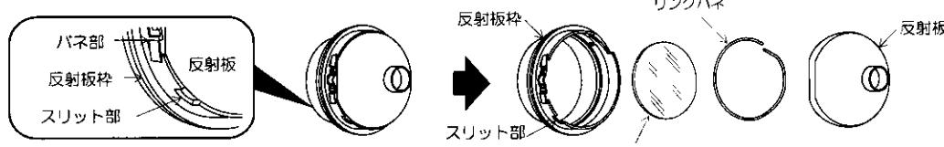
レンズまたはフィルターを反射板枠に入れ、リングバネを取り付けて固定し、反射板のストレート部を反射板枠のバネ部に合わせて確実にはめ込む。取付けが不完全な場合、落下によるけがの原因になります。
