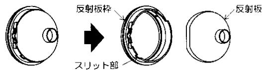
グレアキャップを反射板枠のミゾにはめ込み、反射板のストレート部を反射板枠のバネ部に合わせて確実にはめ込む。
