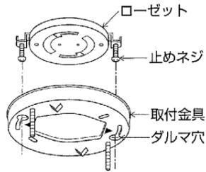
取付金具の矢印(◀▶)を止めネジに合わせて締め付ける。
