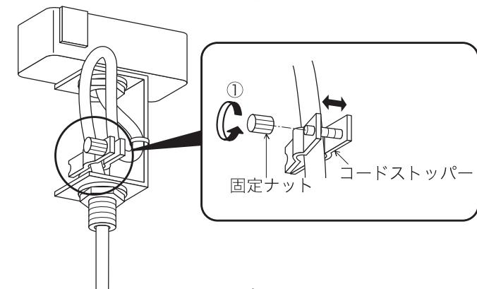
②電源コードの長さを調整する。
