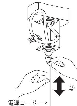
③コードストッパーを必ず元の位置まで戻し、固定ナットで確実に締め付ける。
