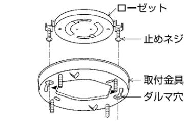
取付金具の矢印(◀▶)を止めネジに合わせて締め付ける。
