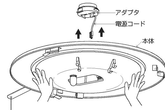
△警告 緑の先端が両端にくるまで本体を押し上げてください。取付けが不完全な場合、落下によるけがの原因になります。
