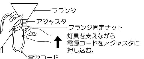
※電源コードの調整が固い場合は、一旦、フランジ固定ナットをアジャスタから取り外し、もう一度2回転程締め付け、仮止めしてください。
