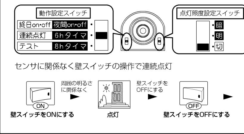
※電源投入後、約20秒間点灯し、その後約40秒間に明るくても人を感知するごとに約5秒間点灯します。
