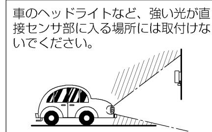
車のヘッドライトなど、強い光が直接センサ部に入る場合には取付けないでください。
