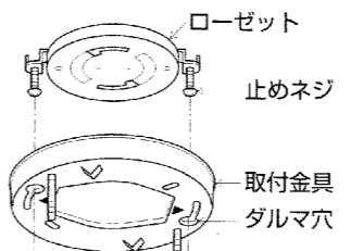
取付金具の矢印(◀▶)を止めねじに合わせて締め
