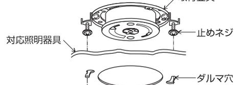
④対応照明器具を回転させ、止めネジを締め付けて取付ける。
