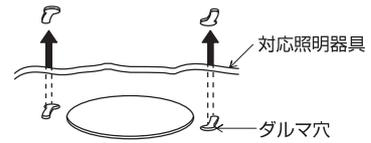
③対応照明器具のダルマ穴を取付金具の止めネジに合わせる。
