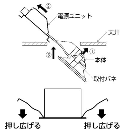
※天井材厚が薄い場合、天井との間にすきまが空くことがありますので、この場合は一度パネを押し広げてから埋込穴に挿入してください。
