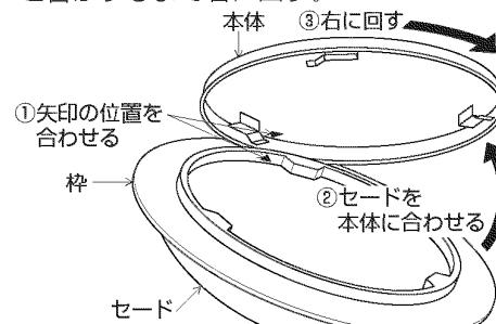
△警告 セードが確実に取付いたことを確認してください。取付けが不完全な場合、落下によるけがの原因になります。
