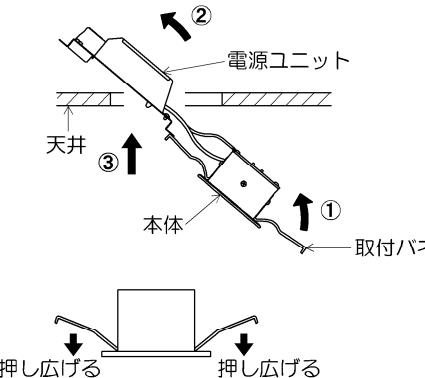
※天井材厚が薄い場合、天井との間に隙間が空くことがありますので、この場合は一度バネを押し広げてから埋込穴に挿入してください。
