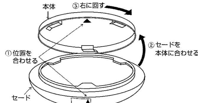
△警告 セードが確実に取付いたことを確認してください。取付けが不完全な場合、落下によるけがの原因になります。
