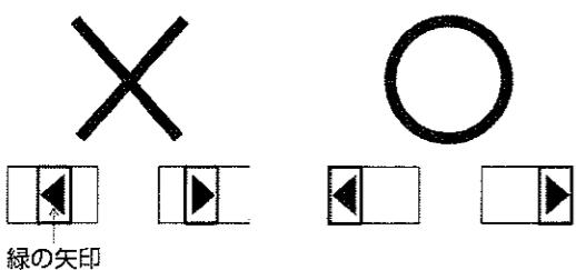
△警告 緑の先端が両端にくるまで本体を押し上げてください。取付けが不完全な場合、落下によるけがの原因になります。
