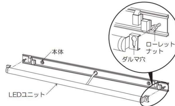
LEDユニットを回転させ、ローレットナットを締め付けて取付ける。
