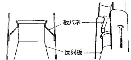
※反射板を取付ける際、反射板や板バネ、本体などに落下防止ワイヤーをはさみ込まないように行ってください。
