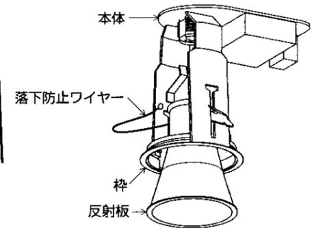
△警告 落下防止ワイヤーがランプやソケットに触れないようにしてください。火災・感電の原因になります。
