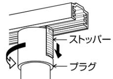
△ 警告 プラグのストッパーを操作する際は慎重に行なってください。プラグが損傷すると火災・落下によるけがの原因になります。
