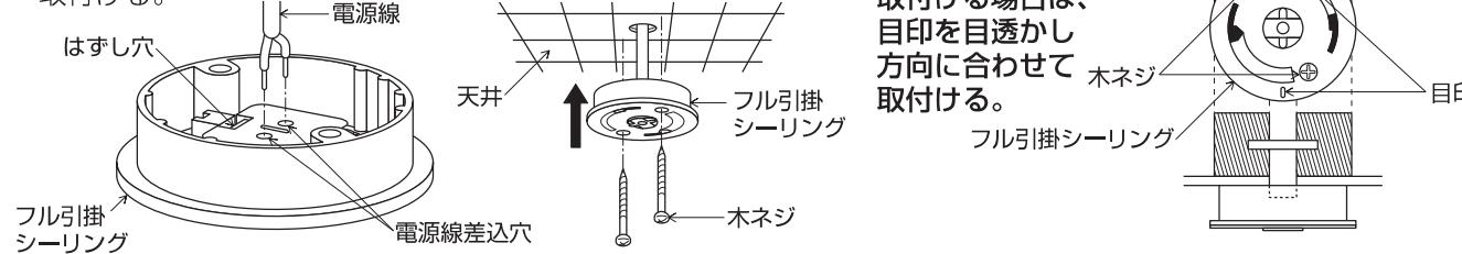
■取付手順 △注意 取付けの際は必ず電源を切ってください。感電の原因になります。
