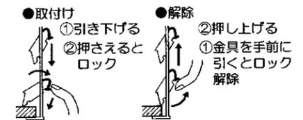
6 反射板枠を取付ける
