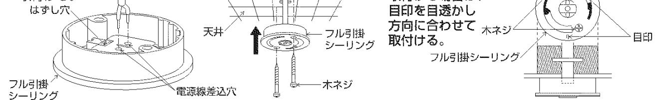
※目透かし天井に取付ける場合は、目印を目透かし方向に合わせて取付ける。
