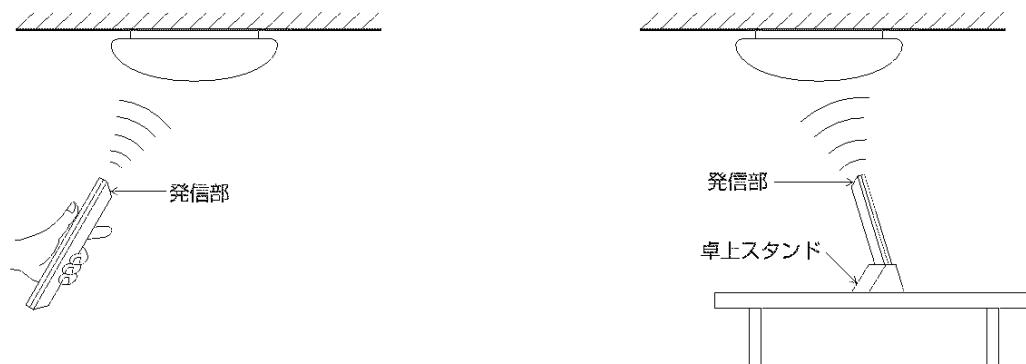
※タイマー作動中にはリモコン送信機は、付属の卓上スタンドを使用して照明器具の真下など、必ずリモコンが動作する場所に置いて使用してください。
