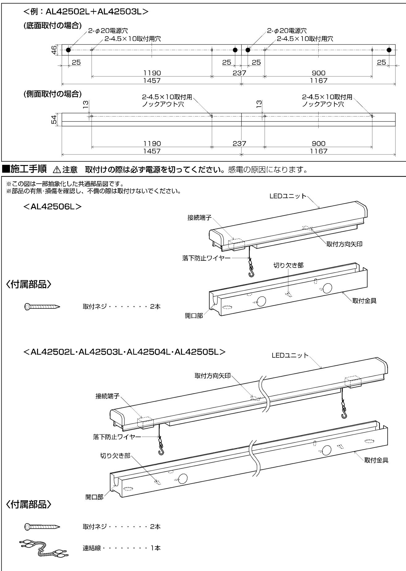
**施工手順** **△注意** 取付けの際は必ず電源を切ってください。感電の原因になります。
